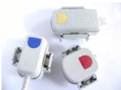
**Caja de derivación:** son conectores para salidas de la barra. Existen con y sin fusibles, son de 4 y 6 polos; constan de dos contactos móviles de 10 A para seleccionar la fase de alimentación, el cable de conexión no debe ser mayor a 9 mm de diámetro
